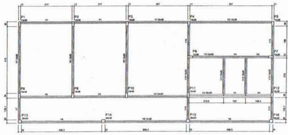
2 FORMA DO PAVIMENTO NÍVEL 000 ESCALA: 1/50
