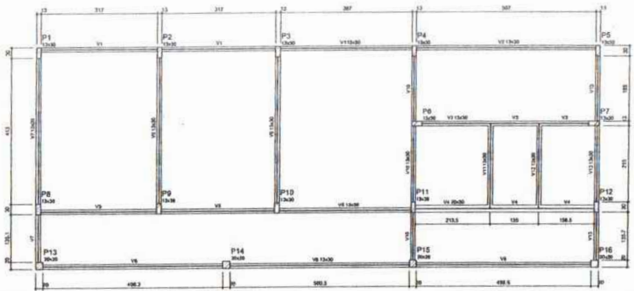
2 FORMA DO PAVIMENTO NÍVEL 000 ESCALA: 1/50
