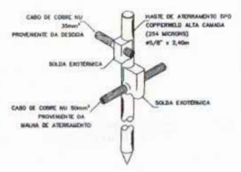
7 DET. - HASTE DE ATERRAMENTO REVISÃO
